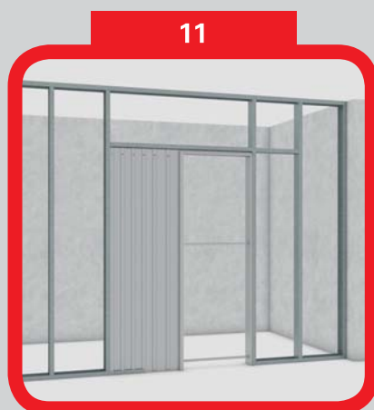
Usazené pouzdro v SDK konstrukci
